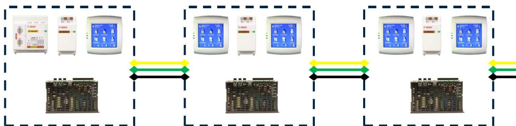
Figura 1.1: Cablagem dos segmentos de fonte de alimentação
