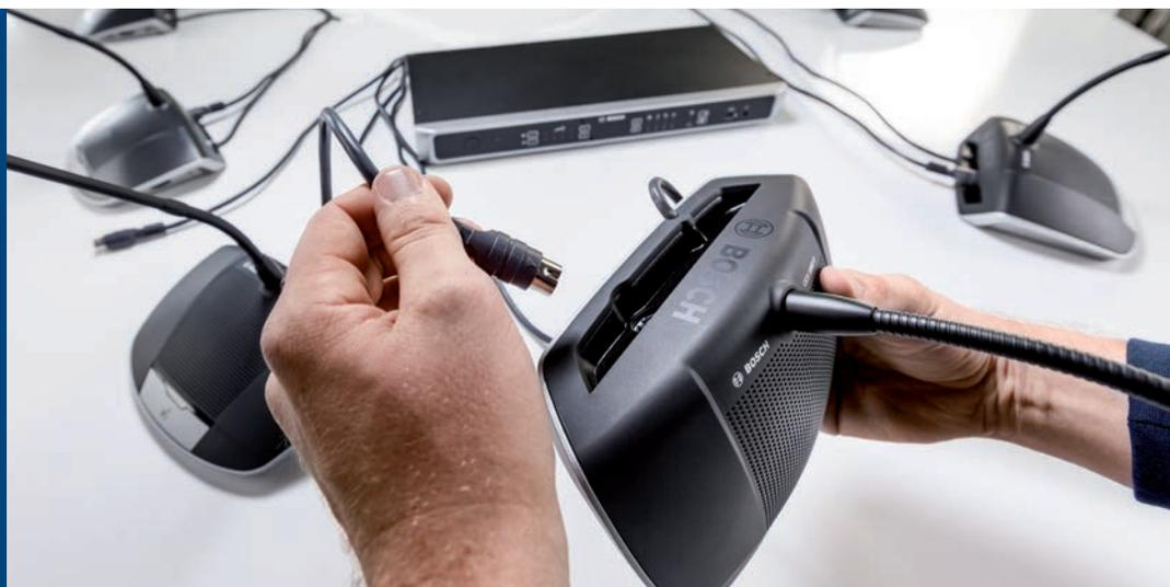
O sistema é muito rápido e fácil de instalar. Sem necessidade de formação ou equipamento adicional: os dispositivos de debate são ligados diretamente à unidade de controlo através de uma ligação por cabo simples, do tipo “daisy chain”.
