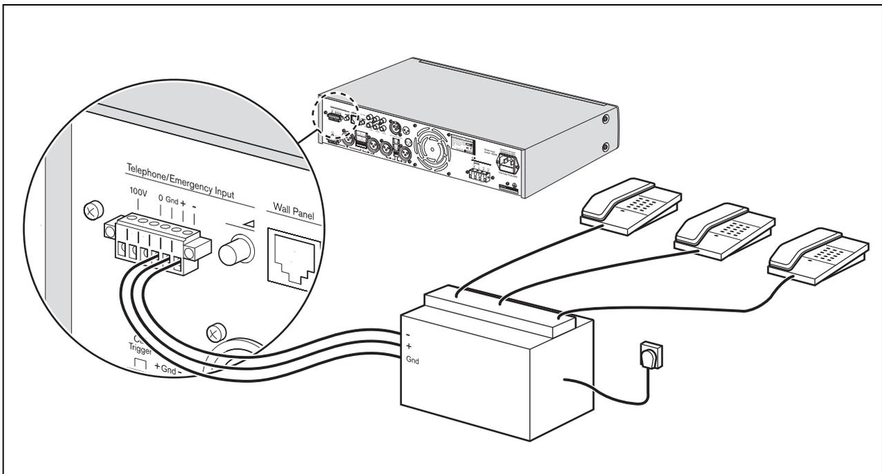
figura 4.6: Ligar linhas telefónicas de emergência
