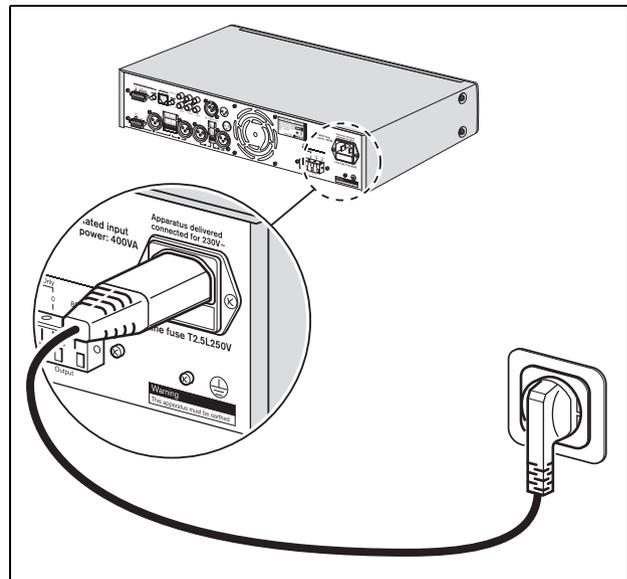
figura 3.2: Ligação eléctrica e selector de tensão
