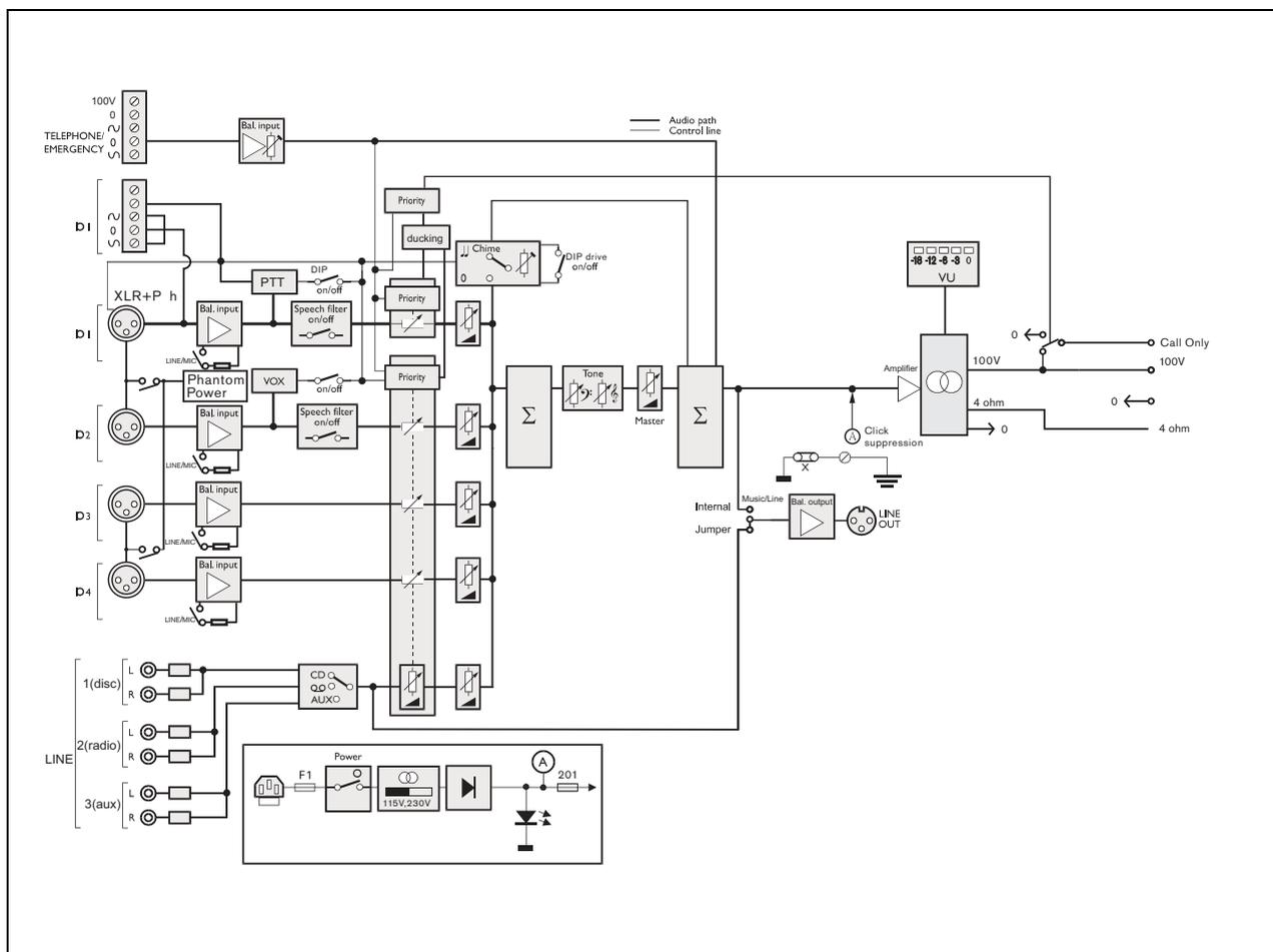
figura 2.1: esquema do Plena Mixer Amplifier
