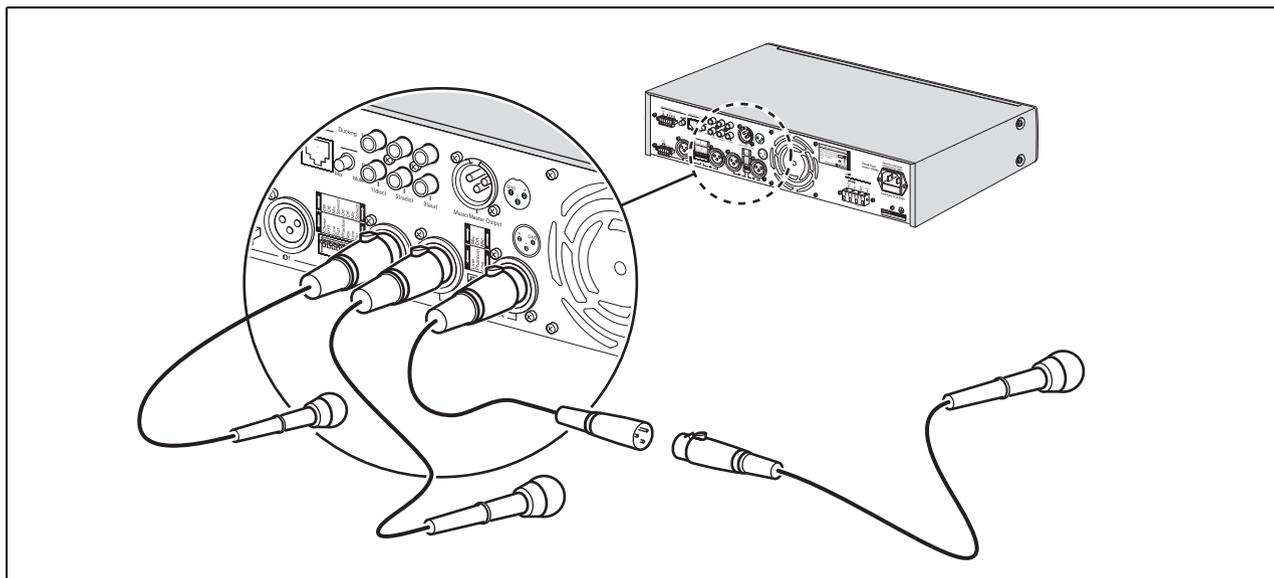
figura 4.4: Ligação das entradas do microfone
